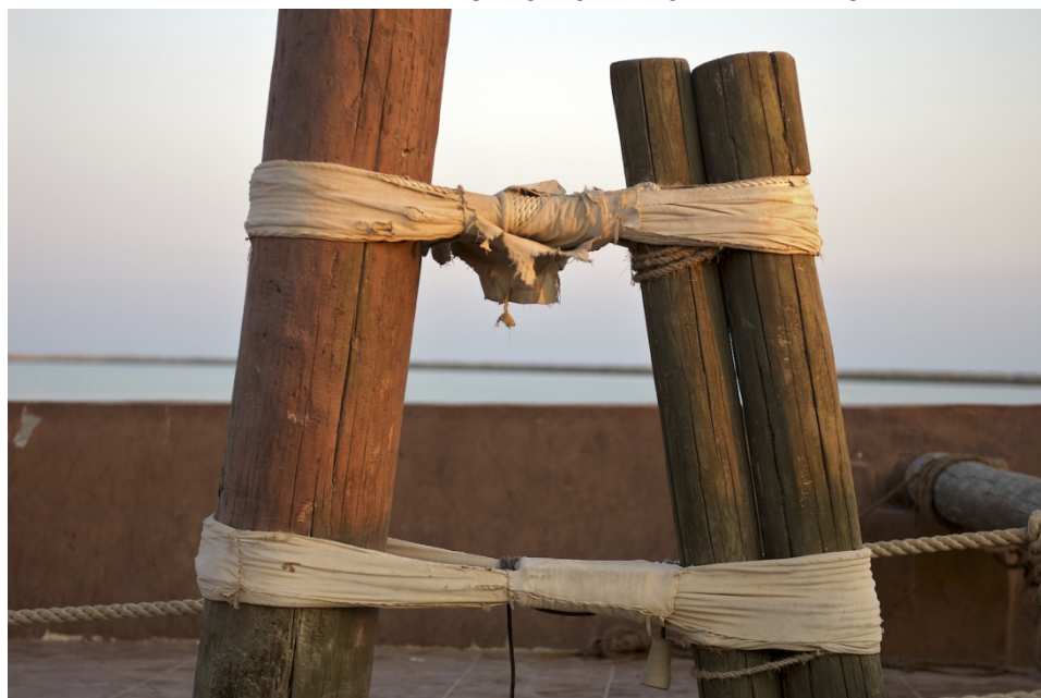
Figure 38 طرز بستن دکل (سمت چپ) به عبد. عبد و دکل را با طناب‌هایی به نام زیوارد به هم می‌بستند و روی آن پارچه‌ای به نام سیان می‌کشیدند و رنگ سفید می‌زدند. بر خلاف این عکس عبد معمولاً از یک چوب تشکیل می‌شد. این عکس را حمید اسکندری از یادبود بوم مسی در بندر کنگ گرفته است.
