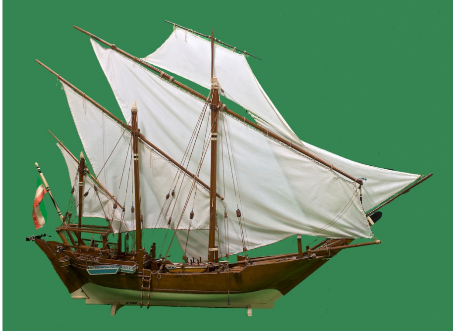
Figure 36 نمونه کوچکی از بوم بادبان‌های کامل. بالاترین بادبان در این عکس گابیه است. بادبان کوچک سمت چپ تاپسر نامیده می‌شود. این نمونه در خانه آقای محمد ابراهیمی است که خانه خود را به موزه‌ای از سنت دریانوردی بندر کنگ تبدیل کرده‌اند.
