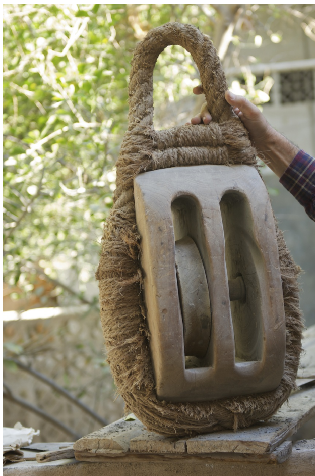
Figure 40 یک گفیه قدیمی. یکی از گردها یا چرخ‌های این قرقره در فاح سمت راست شکسته و سنقریر یا محور قرقره دیده می‌شود.
