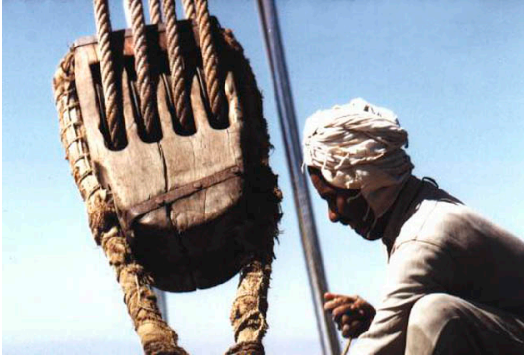
Figure 39 جامع. ظاهرا این جامع قدیمی پس از به کار رفتن بسیار ترک برداشته بوده و آن را با تسمه‌ای آهنی محکم کرده بودند. از عکس‌های ماریون کاپلان
